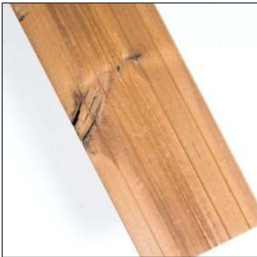
Praskliny kolem suků jsou povoleny
