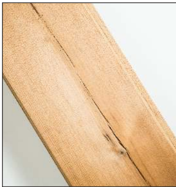
Malé praskliny na povrchu prken jsou povoleny
